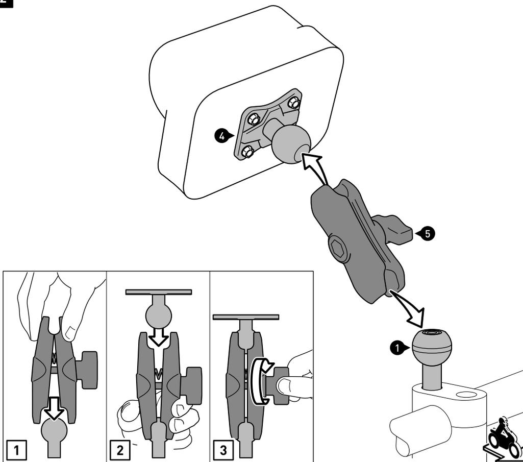
Verschrauben Sie Ihr Navi Case Pro bzw. GPS-Gerät mit dem Kugelgelenk mit Montageplatte (4).
