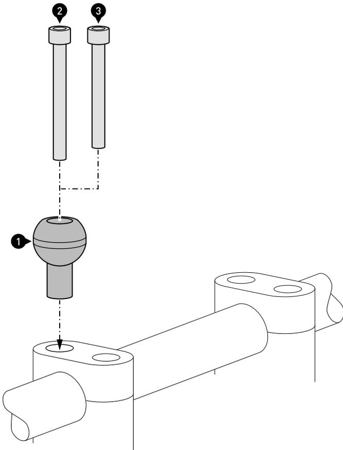
**ACHTUNG:** Nehmen Sie diese Befestigungsmöglichkeit nur wahr, wenn der vom Fahrzeughersteller angegebene Anzugsmoment der Lenkerklammerschrauben nicht über 9,6 Nm liegt!
