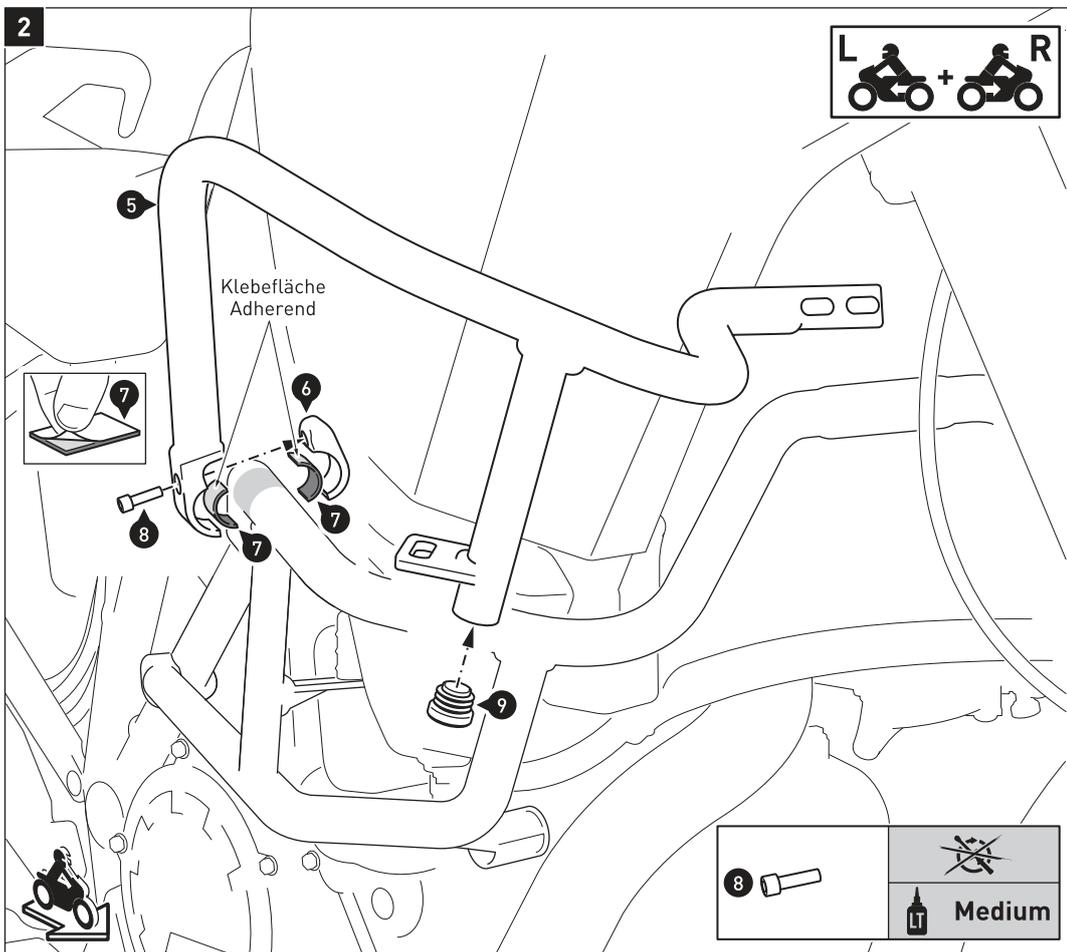
Reinigen Sie die Oberflächen der Schellen (6) und der an den Sturzbügeln verschweißten Schellen vor dem Aufkleben der Gummieinlagen (7) gründlich von Fett- und Schmutzrückständen.
