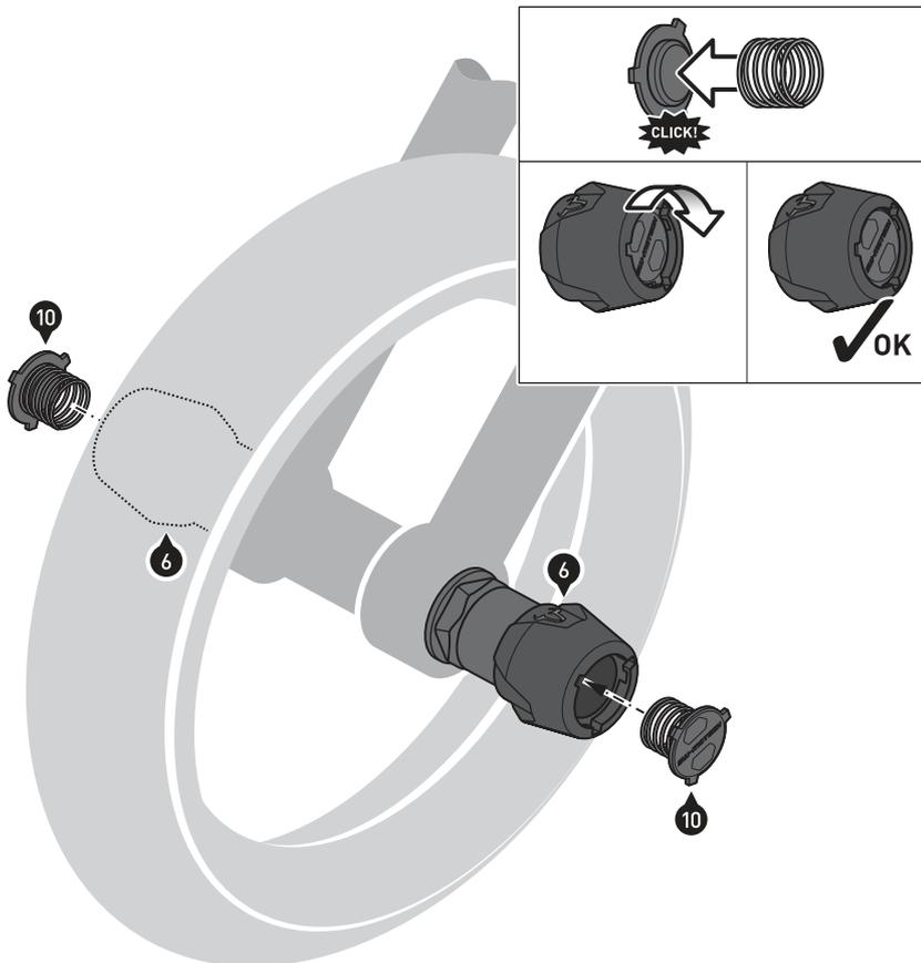
Setzen Sie **beidseitig** die Abdeckkappen (10) in die Öffnungen der montierten Sturzpads (6) ein und drehen Sie diese bis in die Endposition. **ACHTUNG: Achten Sie auf den festen Sitz der Abdeckkappen (10).**
