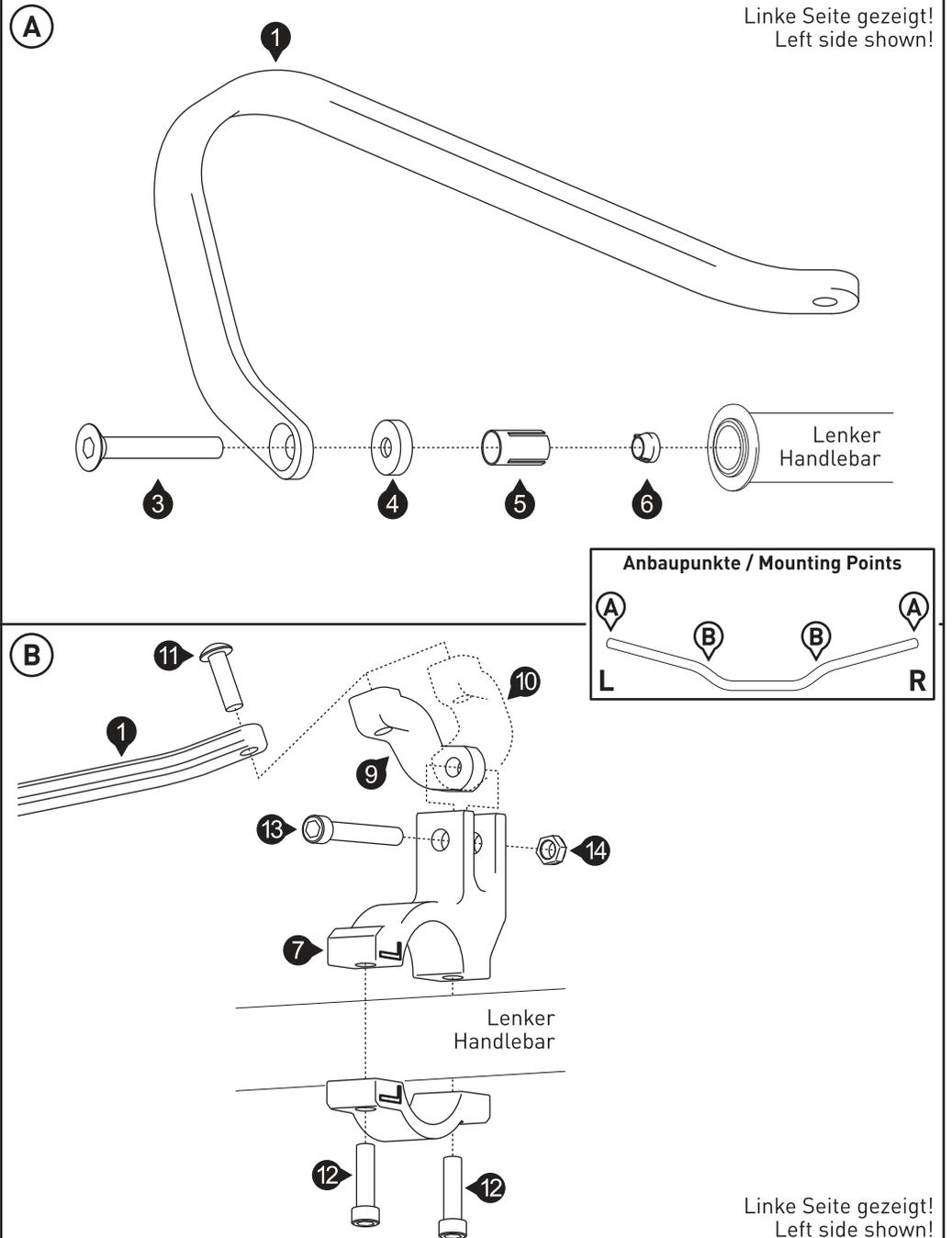
**Handprotektoren Montage-Kit Ergänzung****Handguard Mounting Kit Addition**
