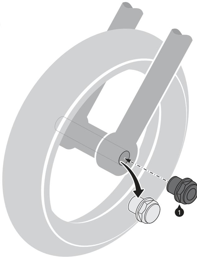
Entfernen Sie auf der linken Fahrzeugseite die original Achsschraube.
