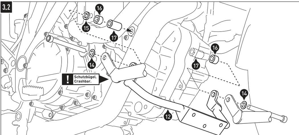
**Schritt 3.2: Montage mit dem SW-MOTECH Schutzbügel.**
