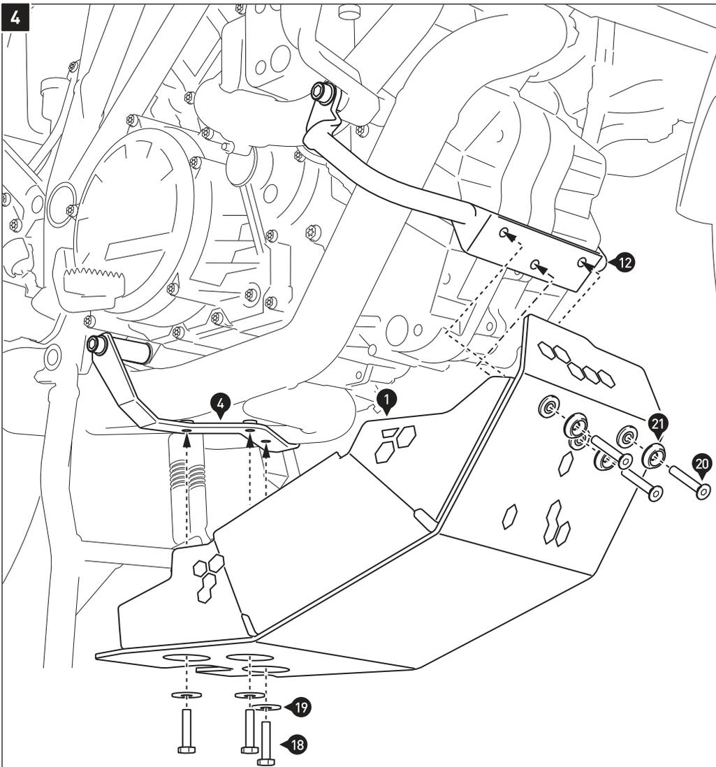
Verschrauben Sie den Motorschutz (1) an dem Anbaublech (4) und dem Montagebügel (12), wie in der Zeichnung gezeigt.
