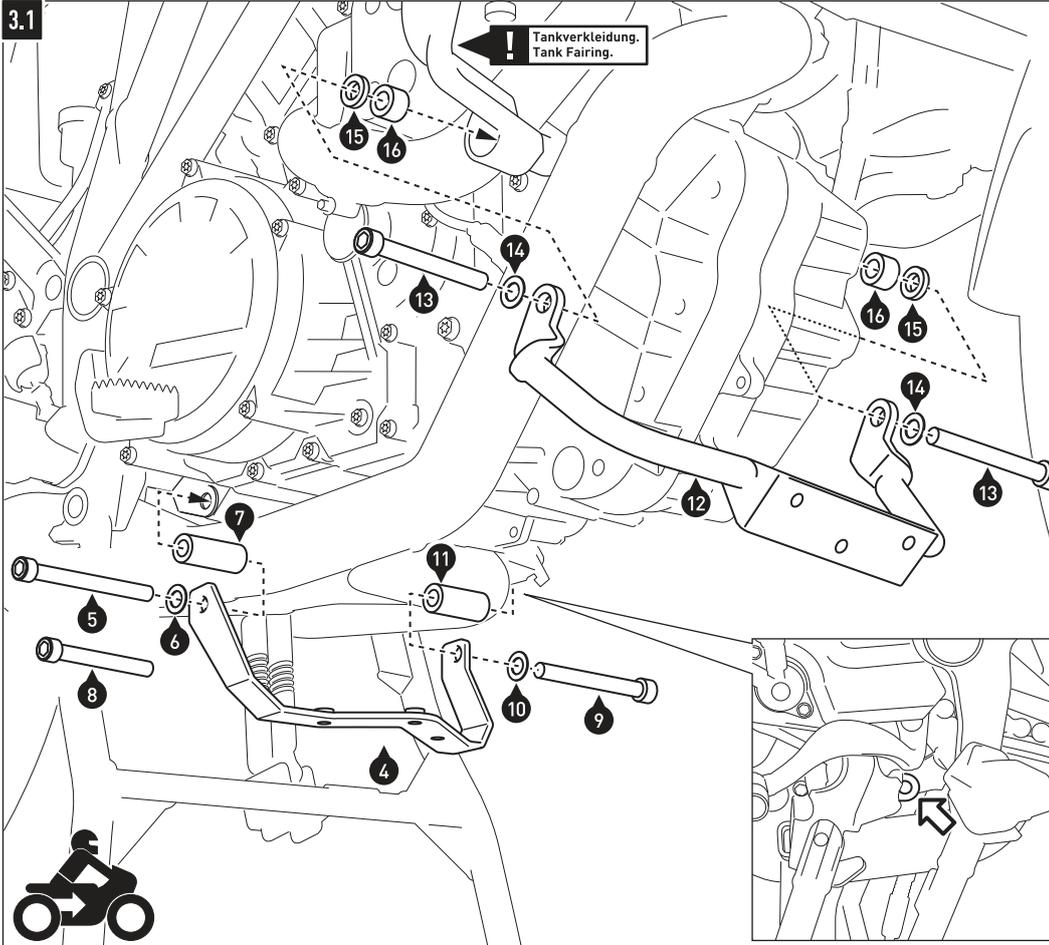
**Schritt 2.1: Montage mit den originalen Tankverkleidungen.**
