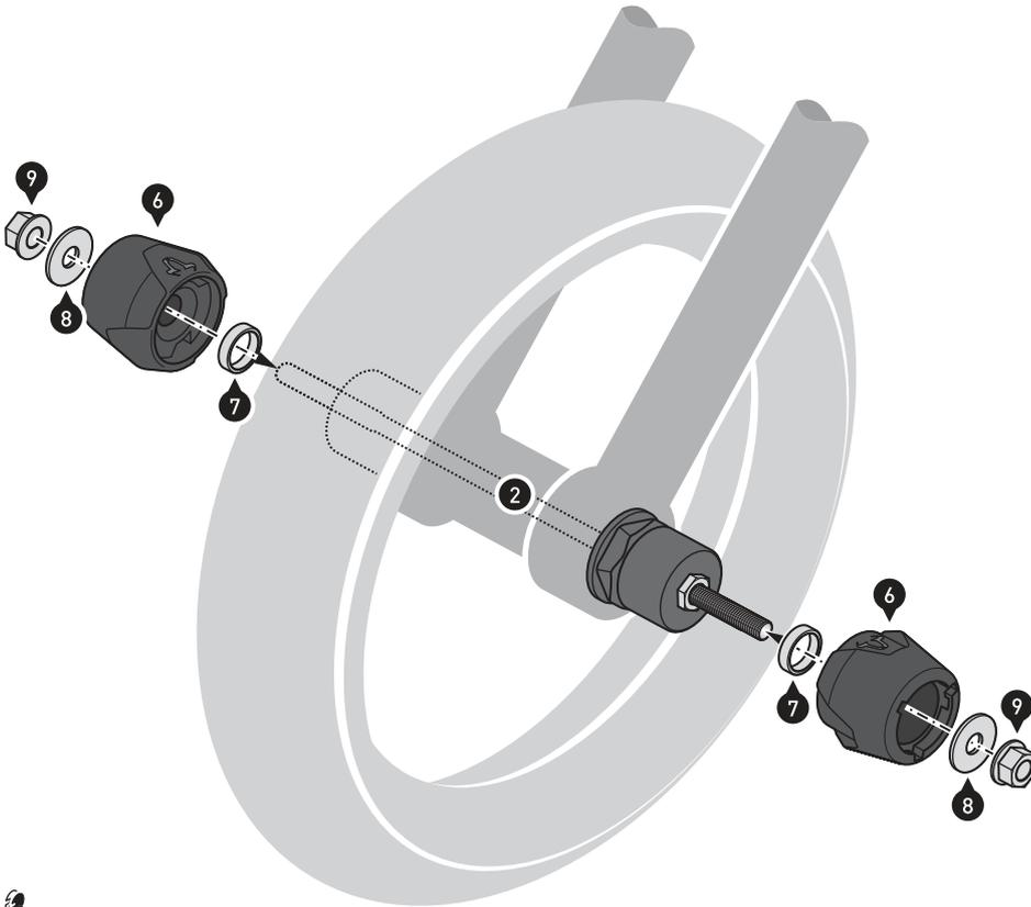
Montieren Sie die Sturzpads (6) mit den Muttern (9) **beidseitig** an der Gewindestange (2). Ziehen Sie die Muttern (9) wie vorgegeben an.
