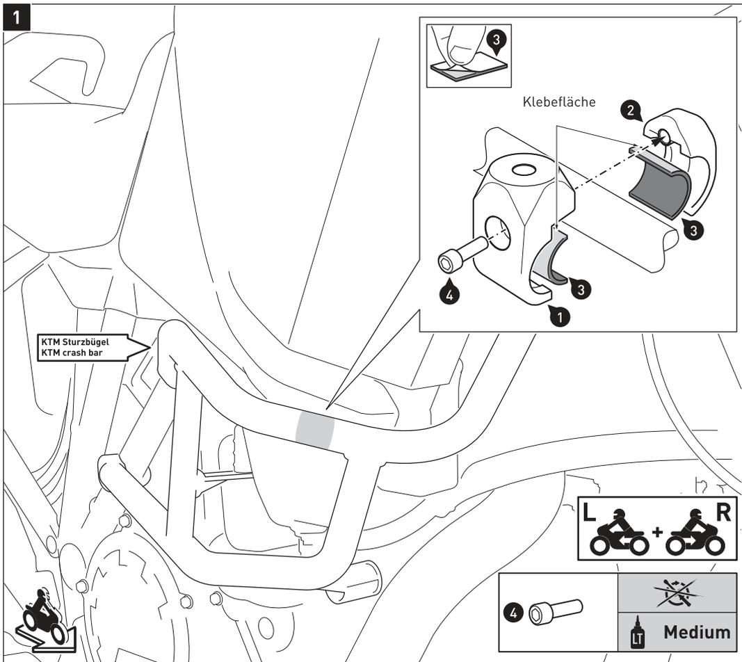
Reinigen Sie die Oberflächen der Schellen (1) und (2) vor dem Aufkleben der Gummieinlagen (3) gründlich von Fett- und Schmutzrückständen.
