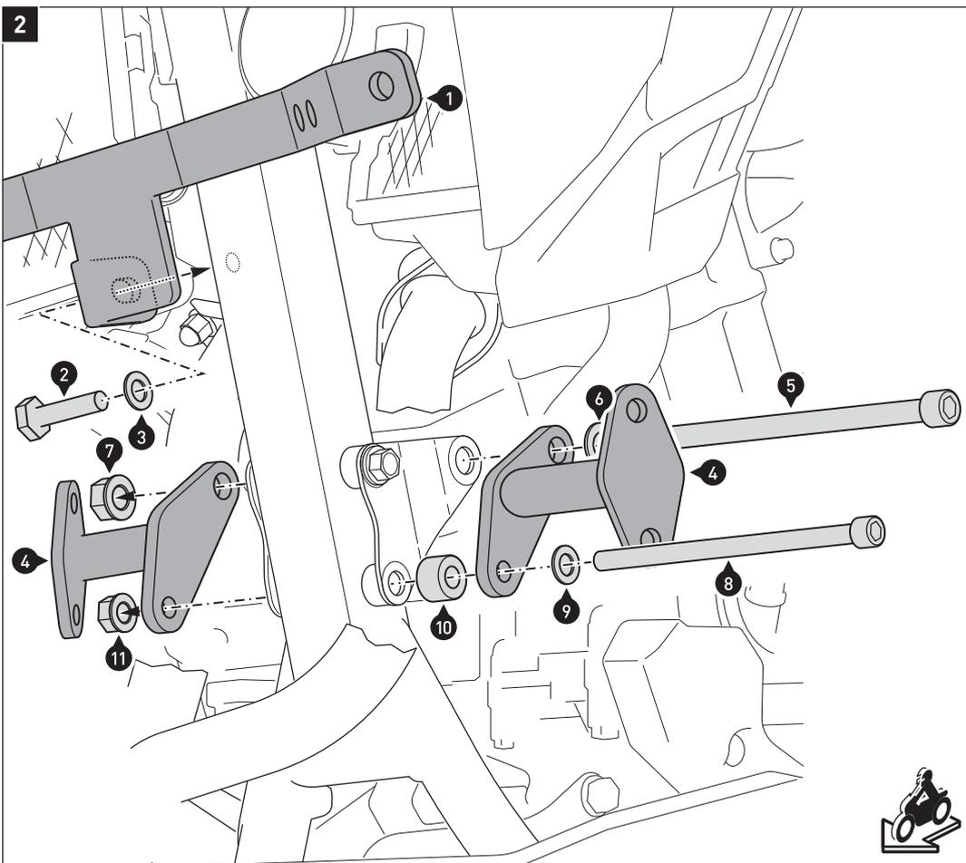
Montieren Sie den Querverbinder (1) und die Anbaustreben (4) am Fahrzeugrahmen.
