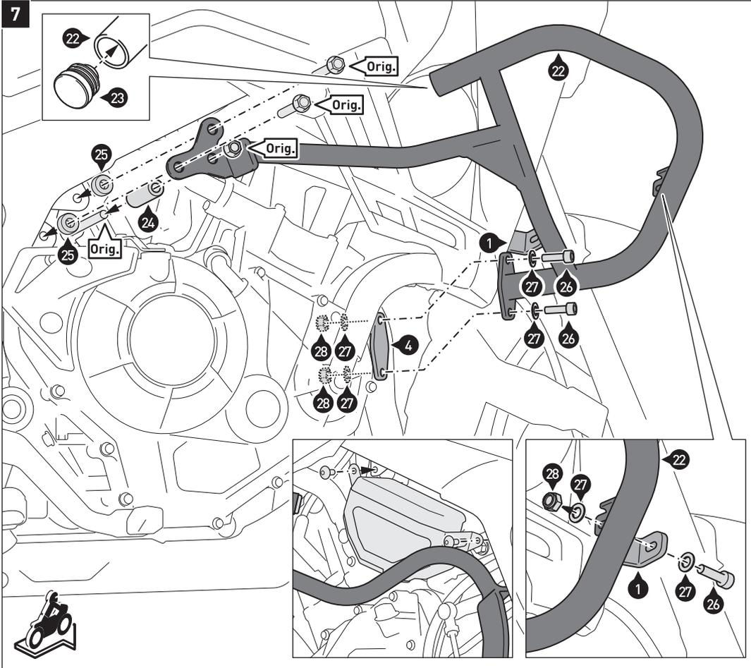
Setzen Sie den Kunststoffendstopfen (23) in den Sturzbügel (22) ein.
