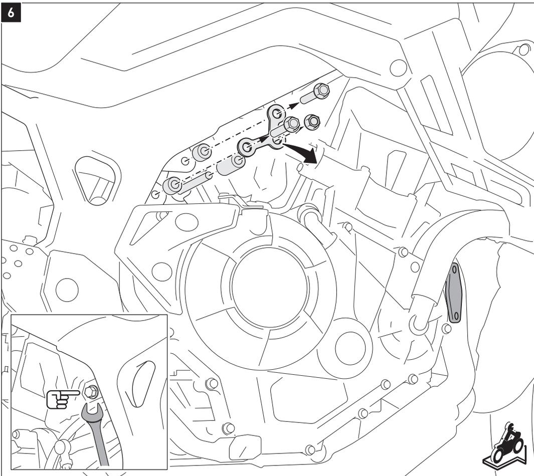
Entfernen Sie die gezeigten original Teile von der rechten Fahrzeugseite. Um die Mutter zu lösen, muss der in der Detailzeichnung gezeigte Schraubenkopf (linke Fahrzeugseite, hinter der Werkzeugbox) gehalten werden.
