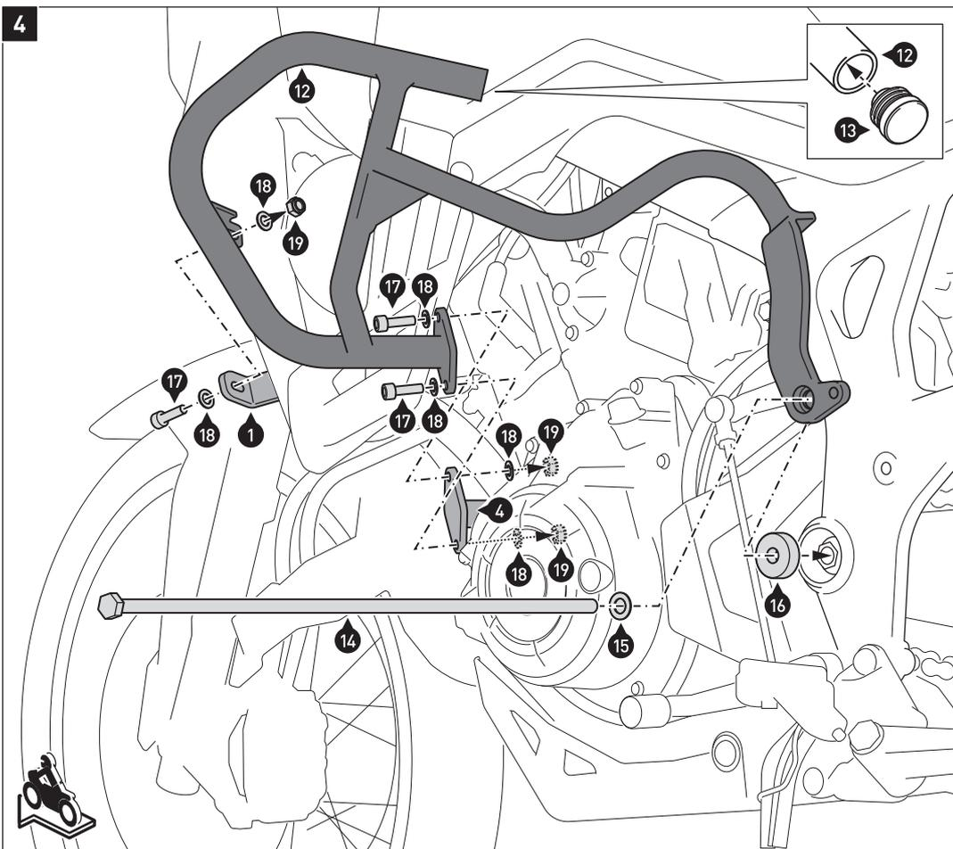
Setzen Sie den Kunststoffendstopfen (13) in den Sturzbügel (12) ein.
