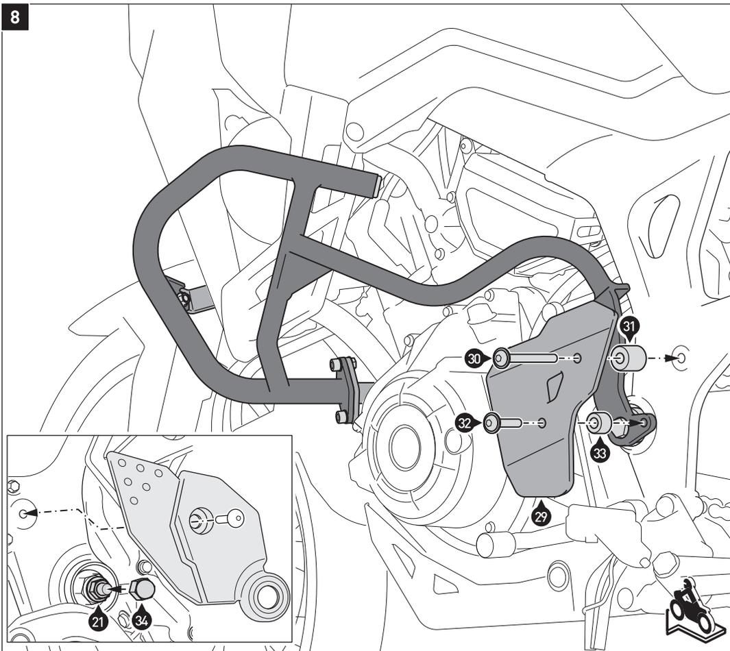
Verschrauben Sie das Abdeckblech (29) auf der linken Fahrzeugseite.
