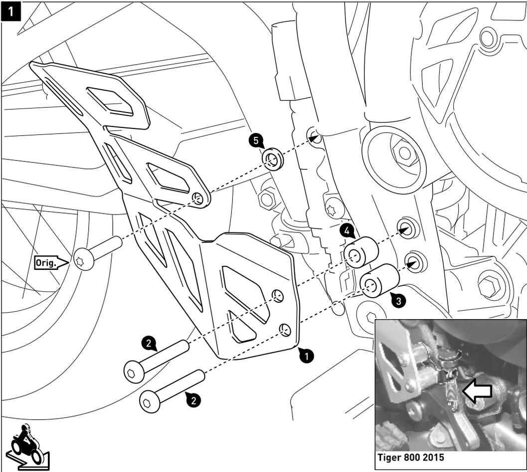
Lösen Sie die Schrauben vom originalen Fersenschutz und entfernen Sie diesen vom Fahrzeug.
