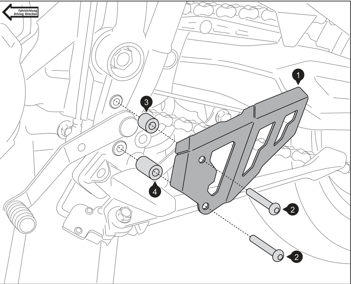
**!** Alle Schrauben mit flüssiger Schraubensicherung montieren!
