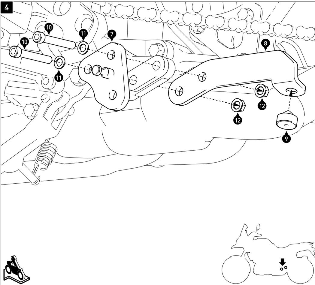
Setzen Sie den Gummidämpfer (9) in das Anschlagblech (8) ein. Verschrauben Sie nun das Anschlagblech (8) mit dem Federanlenkblech (7) am Fahrzeug, wie in der Zeichnung gezeigt. Ziehen Sie die Schrauben wie in der Stückliste vorgegeben an.
