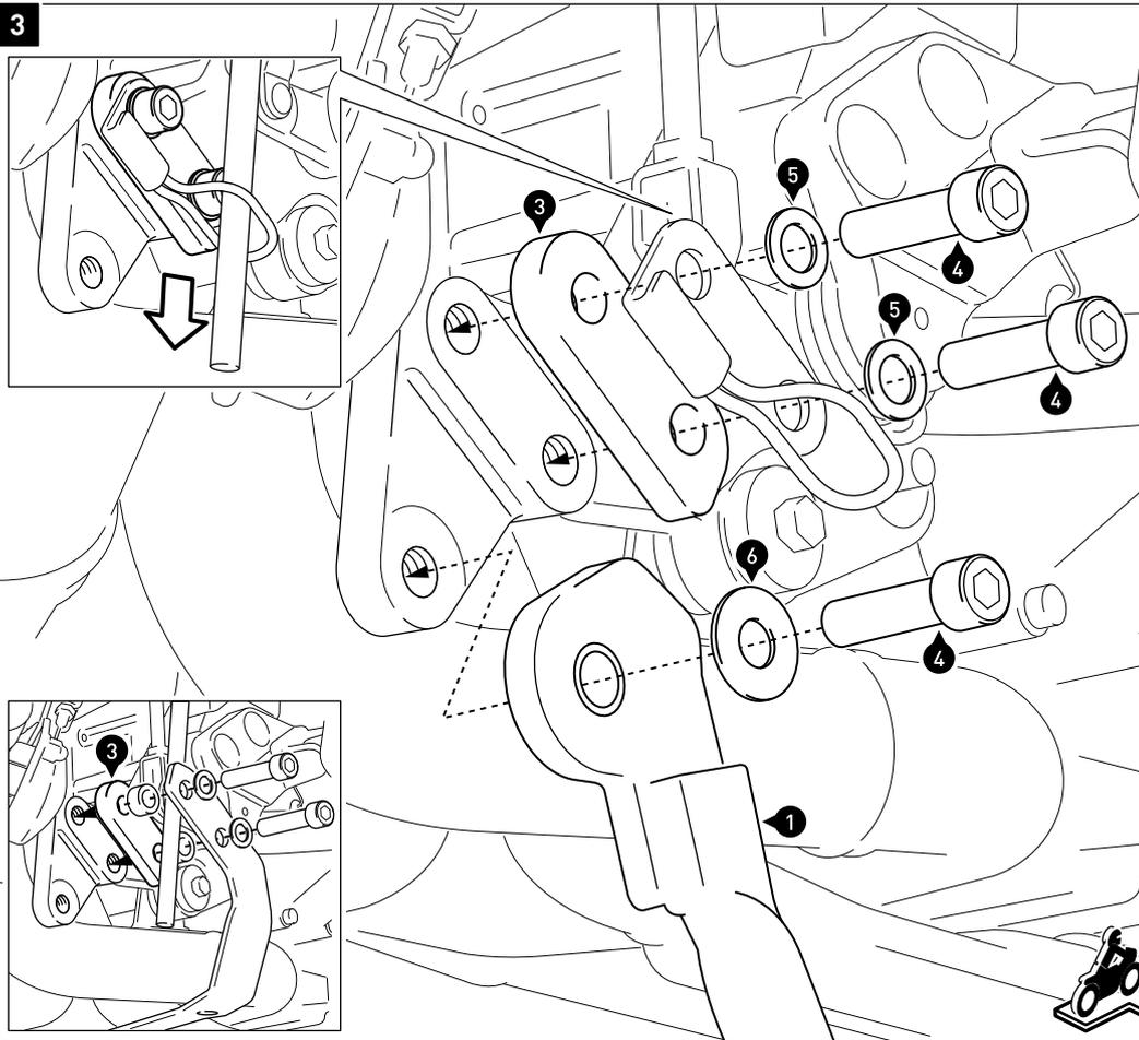
Verschrauben Sie das Anschlagblech (3) mit dem originalen Halteblech am Fahrzeugrahmen, wie in der Zeichnung gezeigt.
