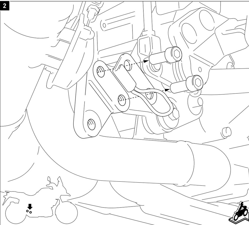
Entfernen Sie das gezeigte Halteblech auf der rechten Fahrzeugseite.
