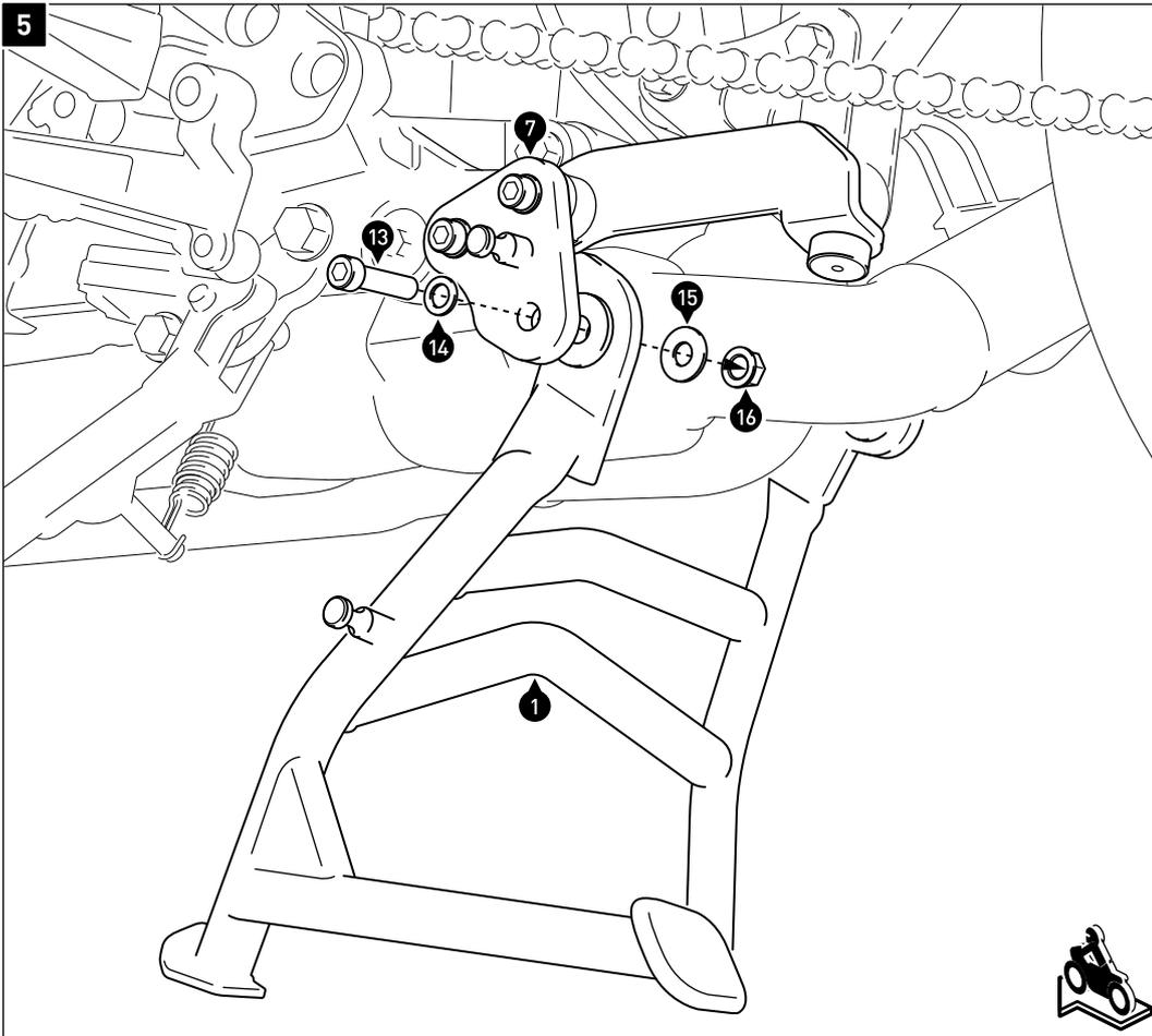
Verschrauben Sie den Hauptständer (1) am Federanlenkblech (7), wie in der Zeichnung gezeigt. Ziehen Sie die Schraube wie in der Stückliste vorgegeben an.
