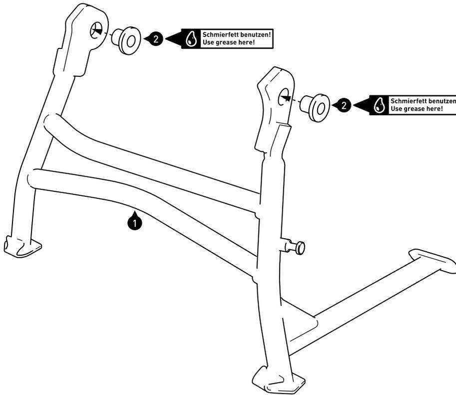
Setzen Sie die Laufbuchsen (2) mit Schmierfett in die Öffnungen des Hauptständers (1) ein.
