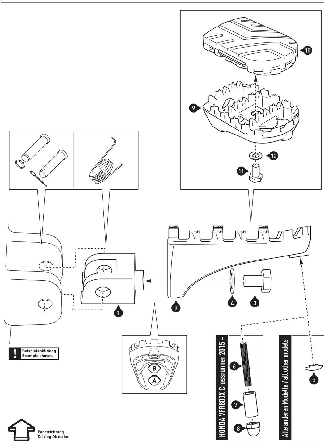
**HINWEIS:** Bitte notieren Sie sich vor Demontage der originalen Fußrasten die Reihenfolge und Ausrichtung der originalen Anbauteile.
